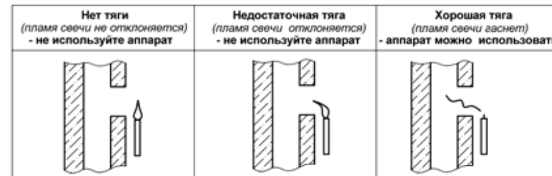
Рисунок 4. Способ проверки тяги в дымоходе
